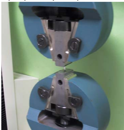
Rys. 7. Widok założonych par wkładek do szczęk chwytających próbki
