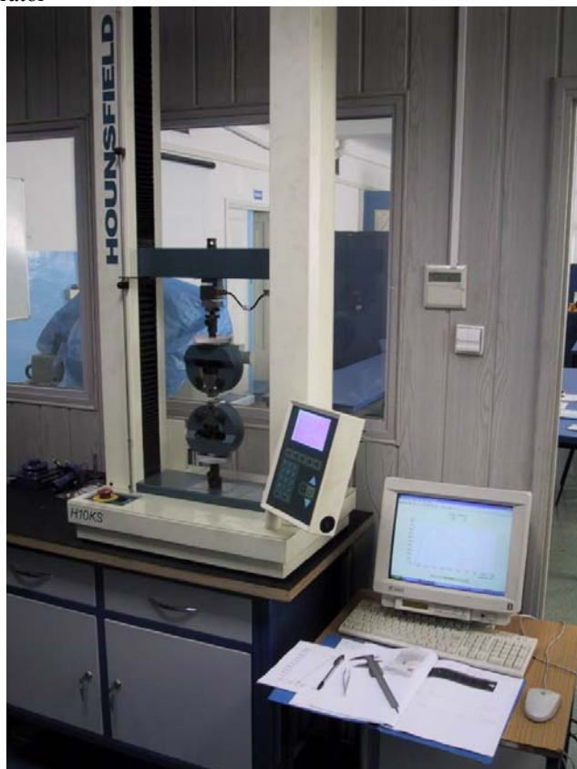
Rys. 4. Widok maszyny H10KS (nr ser. 0541), na której prowadzono próby jednoosiowego rozciągania
