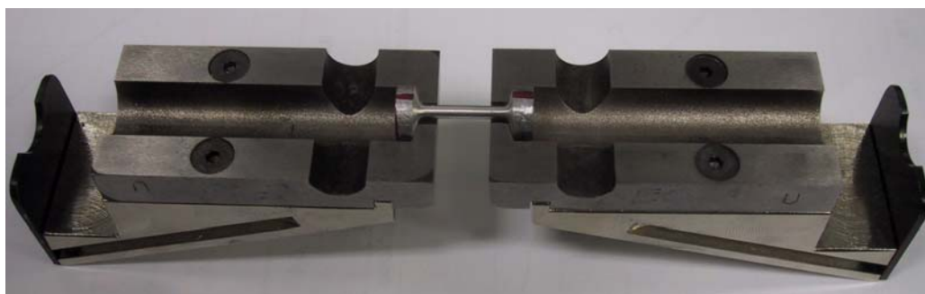
Rys. 6. Sposób ustalenia próbki względem wkładek szczęk chwytających
